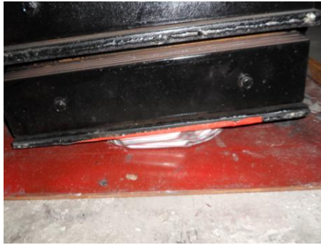
รูปที่ 16 มวลและอุปกรณ์จับแรงที่ถูกกระแทกที่สภาวะสุดท้าย
