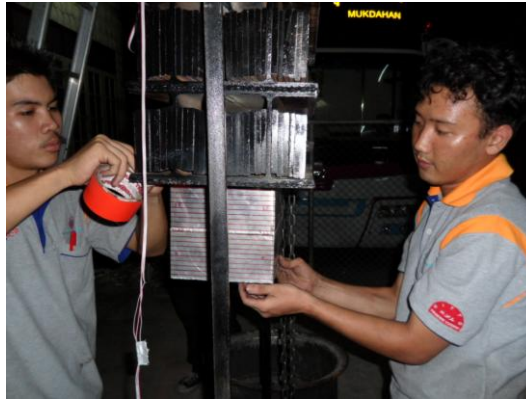
รูปที่ 13 ติดตั้งชิ้นงาน ก่อนทำการทดสอบการชน
