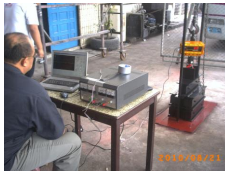
รูปที่ 11 ติดตั้ง Accelerometer ที่มวลน้ำหนัก พร้อมต่อสายไฟ อ่านค่าทาง ออสซิลโลสโคป ผ่านทางเครื่องคอมพิวเตอร์
