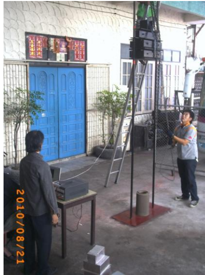
รูปที่ 10 ทดสอบการชน และอุปกรณ์วัดค่า G ก่อนการทดสอบจริง
