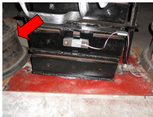
รูปที่ 12 ติดตั้ง Accelerometer วัดค่า G
