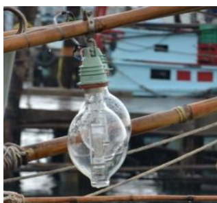
ภาพที่ 1 ลักษณะหลอด HID ที่ติดตั้งกับเรือประมง
