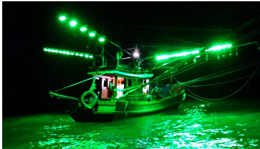
ภาพที่ 11 เรือประมงขณะทดสอบทำประมงโดยใช้หลอดไฟ LED
