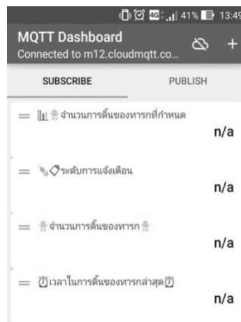
แผนภาพที่ 7 หน้าจอของระบบอินเตอร์เน็ตในทุกสรรพสิ่งสำหรับวัดการเดินของทารกในครรภ์
