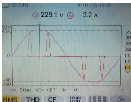
ก. รูปคลื่นกระแสอินพุตที่สายของระบบไฟฟ้า
