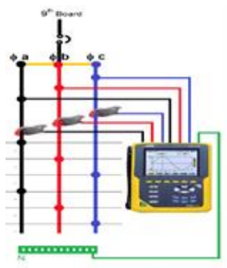
ภาพประกอบที่ 5 ตำแหน่งการวัดแรงดันฮาร์มอนิก และ กระแสฮาร์มอนิก
