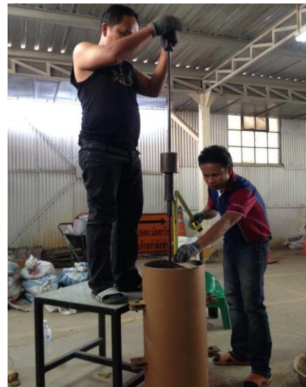
แผนภาพที่ 1 เครื่องมือ Dynamic Cone Penetrometer และการทดสอบตัวอย่างดินบดอัดในห้องปฏิบัติการ
