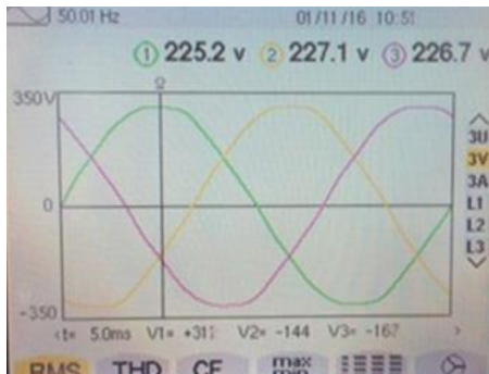
ก. รูปคลื่นแรงดันระหว่างสายของระบบไฟฟ้าอินพุต
