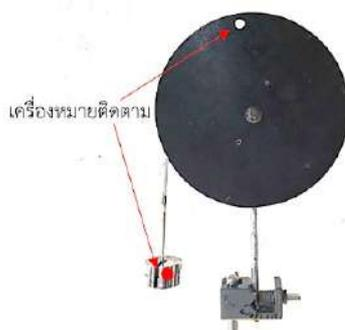
แผนภาพที่ 4 การติดตามการเคลื่อนที่ของตำแหน่งที่ติดเครื่องหมายบริเวณขอบของรอก และมวลถ่วง
