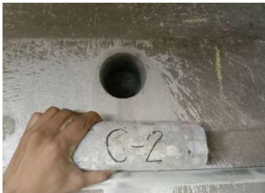
รูปที่ 4 เจาะเก็บตัวอย่างแท่งคอนกรีตด้วยวิธี coring
