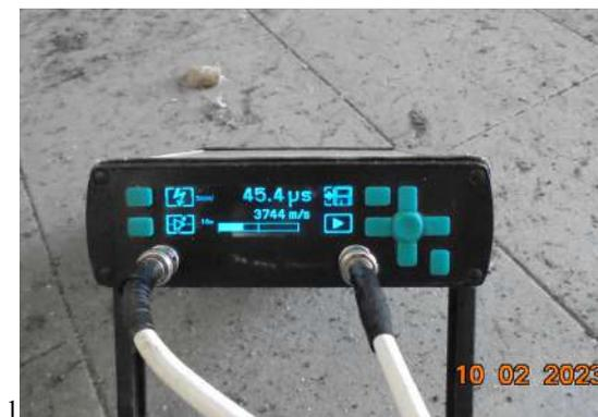
รูปที่ 5 ทดสอบความต่อเนื่องของคอนกรีต โดยวิธี Ultrasonic Pulse Velocity (UPV)
