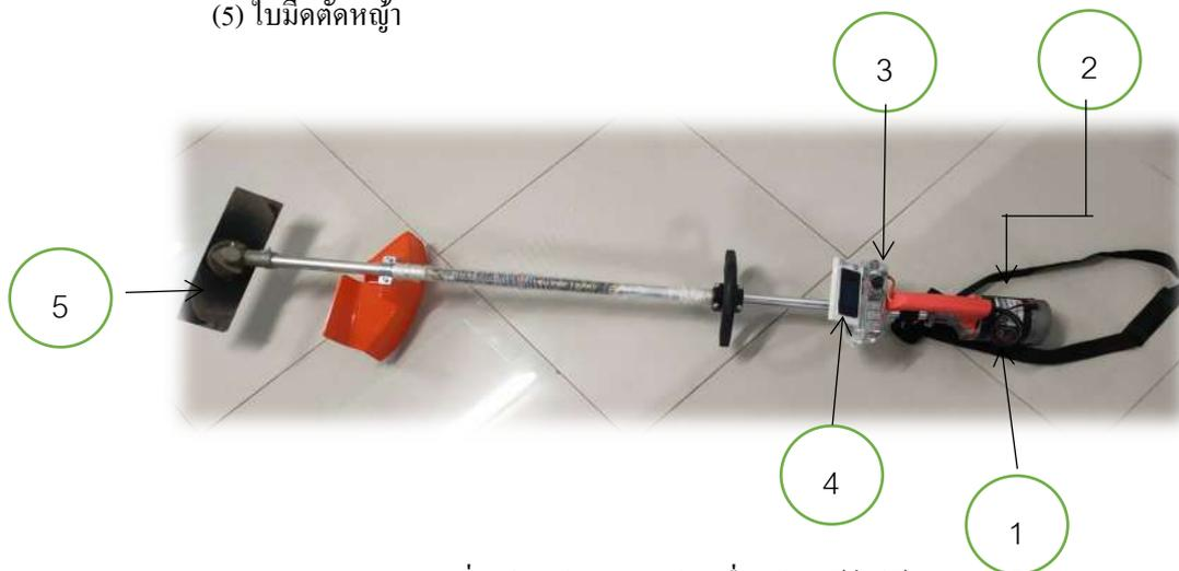
ภาพที่ 1 ส่วนประกอบหลักเครื่องตัดหญ้าไฟฟ้า
