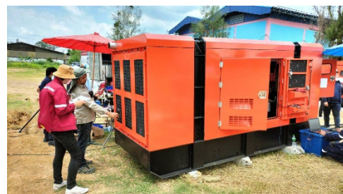
แผนภาพที่ 9 การตรวจวัดอุณหภูมิตามจุดต่างๆ จากหน้างานจริง
