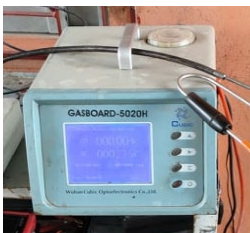
รูปที่ 2 เครื่องวิเคราะห์ก๊าซ CUBIC GASBOARD-5020H
