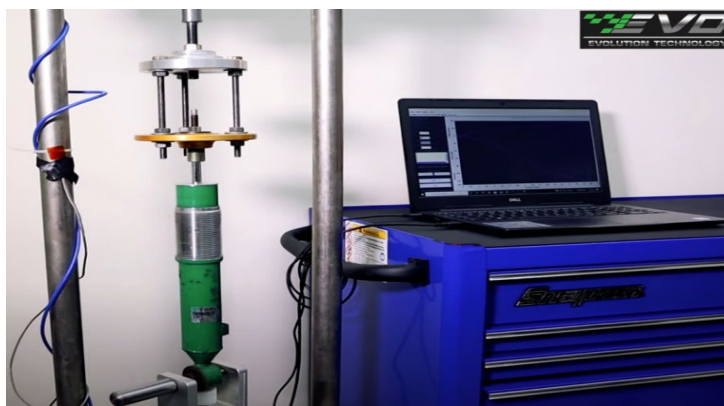
รูปที่ 5 การทดสอบหาค่าแรงหน่วงและค่าสัมประสิทธิ์การหน่วงของโช้คอัพ
