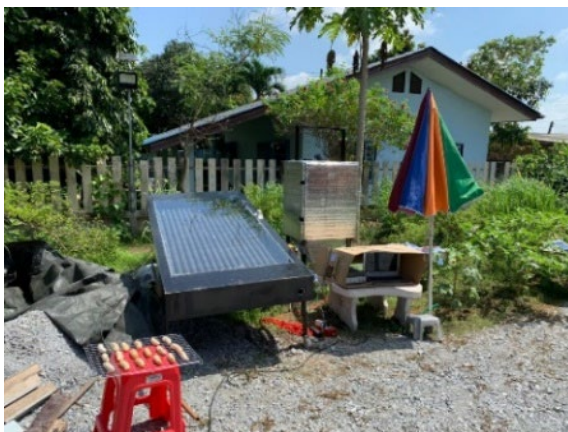
รูปที่ 4 การติดตั้งอุปกรณ์สำหรับการทดลองเครื่องอบแห้งพลังงานแสงอาทิตย์
