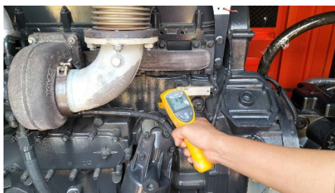
แผนภาพที่ 9 การตรวจวัดอุณหภูมิตามจุดต่างๆ จากหน้างานจริง
