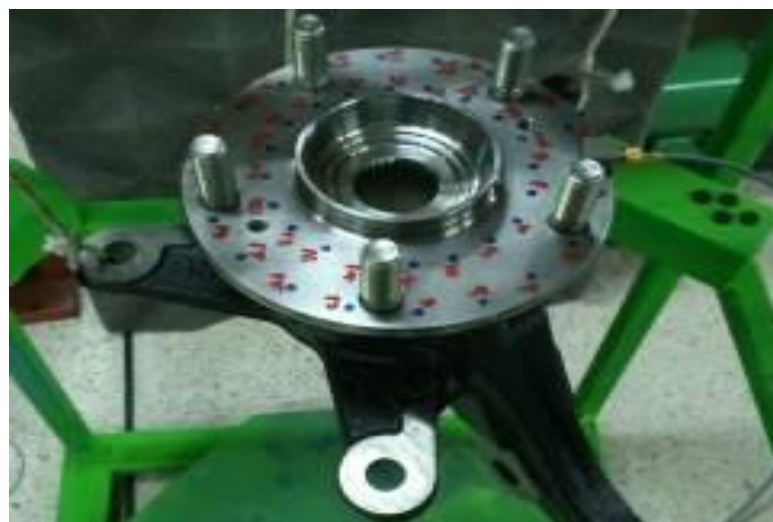
ภาพที่ 5 ภาพแสดง โครงสร้างชุดประกอบแกนล้อ (Hub) และก้านต่อ (Knuckle) ที่นำมาทดสอบด้วยวิธีอิมพีแดนซ์คัปปลิง
