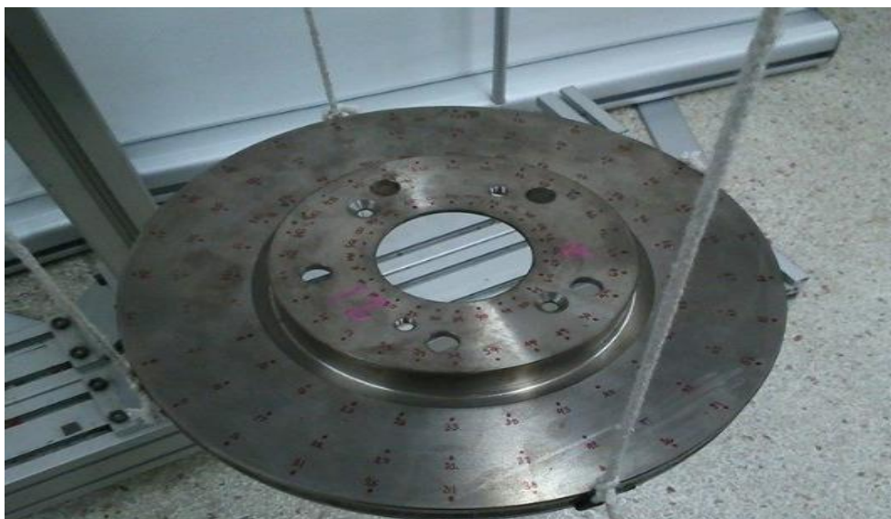
ภาพที่ 2 ภาพแสดงโครงสร้างจานเบรก (Disk Brake) ที่นำมาทดสอบ
