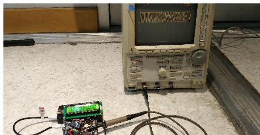
รูปที่ 10 การวัดสัญญาณที่รับได้ด้วยออสซิลอโคปและแสดงผลการรับด้วยจอแอลซีดี
