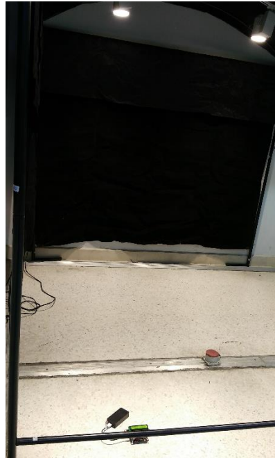
รูปที่ 9 การทดสอบจากโคมไฟมายังอุปกรณ์ตัวรับสัญญาณที่ระยะห่าง 1.80 เมตร
