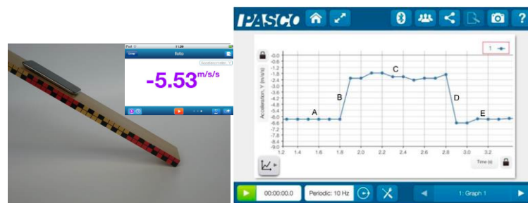
รูปที่ 6 การประยุกต์ใช้เซนเซอร์วัดความเร่งในการทดลองหาค่าสัมประสิทธิ์ความเสียดทานจลน์ของวัตถุที่เคลื่อนที่บนระนาบเอียง (Baldock and Johnson, 2016)
