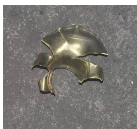
ภาพที่ 17 ความเสียหายที่แผ่นโลหะและลูกกระสุนหมายเลข 5
