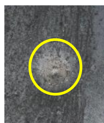
ภาพที่ 16 ความเสียหายที่แผ่นโลหะและลูกกระสุนหมายเลข 4
