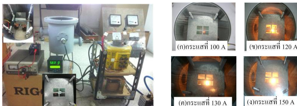
แผนภาพที่ 3 แสดงระบบสุญญากาศเพื่อกำเนิดไอระเหยทั้งสแตนออกไซด์เคลือบลงบนที่กระจก ITO
