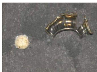
ภาพที่ 15 ความเสียหายที่แผ่นโลหะและลูกกระสุนหมายเลข 3
