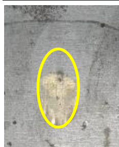
ภาพที่ 21 ความเสียหายที่แผ่นโลหะและลูกกระสุนหมายเลข 9
