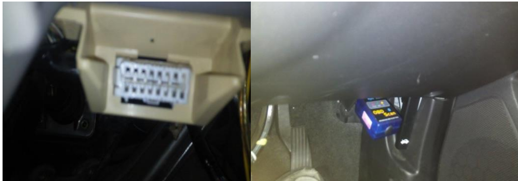
รูปที่ 3 แสดงการเชื่อมต่ออุปกรณ์ตรวจวิเคราะห์รถยนต์ OBD II เข้ากับพอร์ทส่งข้อมูลของรถยนต์
