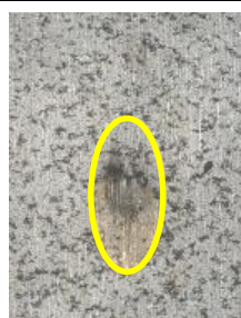
ภาพที่ 22 ความเสียหายที่แผ่นโลหะและลูกกระสุนหมายเลข 10
