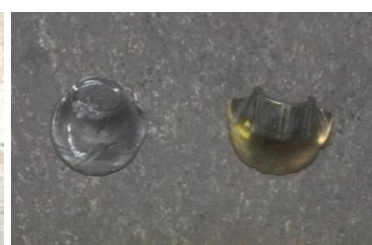
ภาพที่ 20 ความเสียหายที่แผ่นโลหะและลูกกระสุนหมายเลข 8
