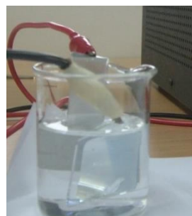
แผนภาพที่ 4 วงจรการทดสอบก่อนการให้แรงดัน ไบอัสกับกระจก ITO /WO 3
