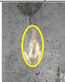
ภาพที่ 11 ความเสียหายที่แผ่นโลหะหมายเลข 9(ทางซ้าย) และหมายเลข 10(ทางขวา)
