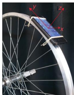
รูปที่ 8 การประยุกต์ใช้เซนเซอร์ไจโรสโคปในการวัดการเคลื่อนที่แบบหมุนของล้อจักรยาน (Patrinopoulos and Kefalis, 2015)
