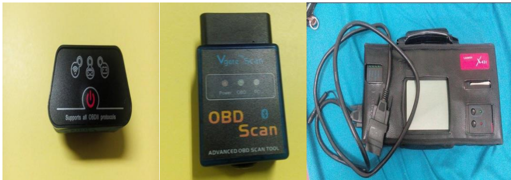
รูปที่ 1 แสดงอุปกรณ์ตรวจวิเคราะห์รถยนต์ OBD II ที่ใช้ในการเก็บข้อมูล
