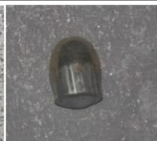
ภาพที่ 22 ความเสียหายที่แผ่นโลหะและลูกกระสุนหมายเลข 10
